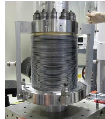
Quelle: Proton OnSite PEM-Elektrolysestack Einzelelektrodenfläche 213 cm 2
