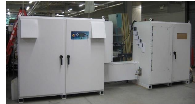
Quelle: Proton OnSite PEM-Elektrolyseur Serie HOGEN C 30 Nm 3 /h
