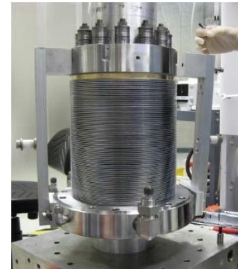
Quelle: Proton OnSite PEM-Elektrolysestack Einzelelektrodenfläche 213 cm 2
